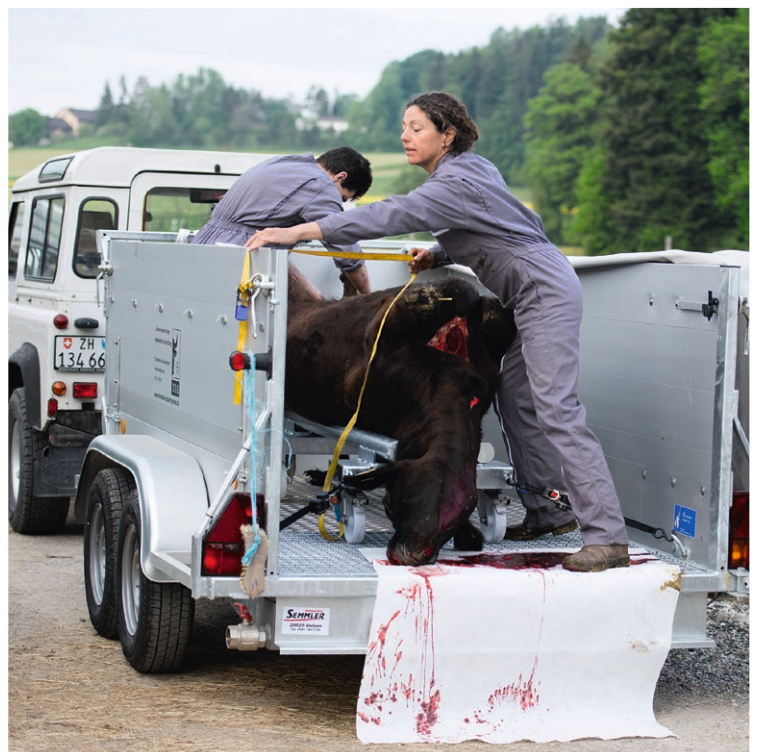
Der für Weideschlachtungen in Deutschland angefertigte T-Trailer besteht grösstenteils aus Aluminium und entspricht den Vorgaben der EU-Hygieneverordnung. Er kann sowohl an einen PKW als auch an einen Traktor angehängt werden. Der Anhänger eignet sich auch für den Transport von Tieren aus Hofhötung.
