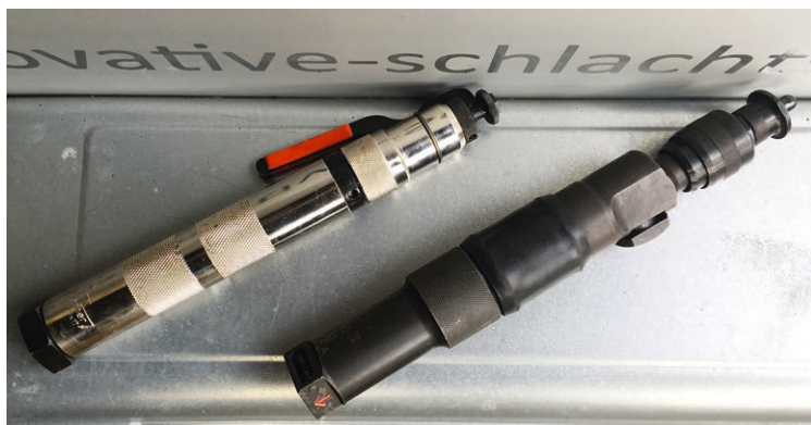
Das Bolzenschussgerät EFA Cash Magnum XL (.25cal) (rechts) ist aus Schwedenstahl gefertigt und eines der hochwertigsten Geräte auf dem Markt. Das Magnum XL und Freeflight haben kein Rückholssystem, dafür mehr Schlagkraft (Joule) und eine höhere Bolzengeschwindigkeit.
