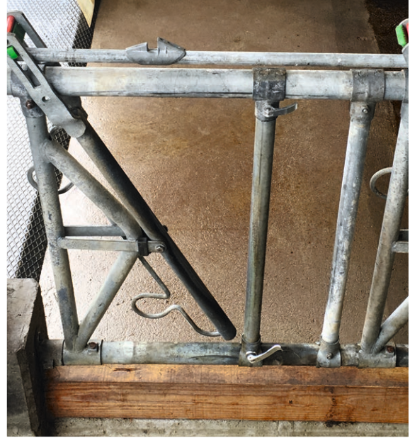
Zur einfachen Befreiung des betäubten Tieres wurden am Fressfanggitter zwei Schnellspannverschlüsse an der normalerweise festen Längsstrebe angebracht. Diese ermöglichen ein einfaches Verschieben und somit Vergrössern des Halsbereichs.
