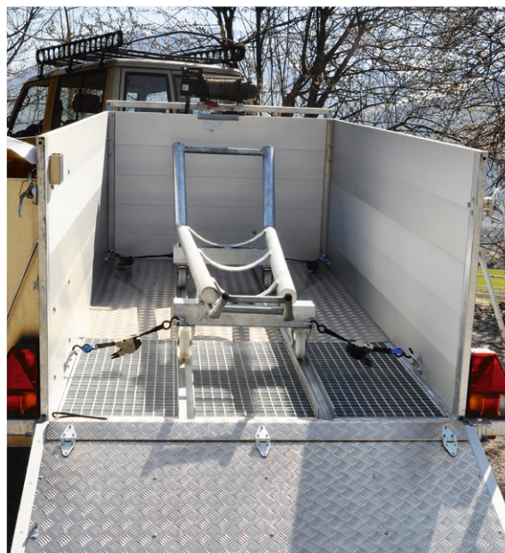
Der für den Transport des toten Rindes zugelassene T-Trailer mit dem Schragen, auf den das entblutete Tier mittels einer Seilwinde gezogen wird. Solche Anhänger ermöglichen den hygienischen Transport des Schlachtkörpers in ein nahegelegenes Schlachtlokal.
