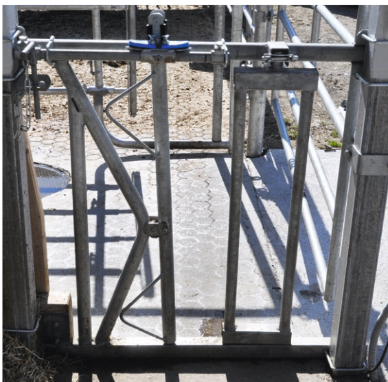
Das Fressfanggitter ist mit einem selber konstruierten Bügel mit Schnellverschluss versehen.
