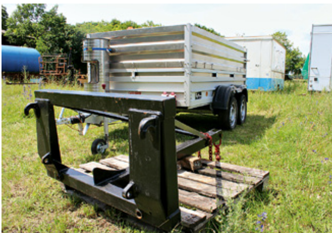
Verlade- und Transporttechnik: Mit dem Lasthaken für den Frontlader werden die Tiere auf den Anhänger gehoben.
