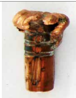
Geschoss 30.06 TTSX nach dem Ausschuss (Foto: S. Retz) Fig. 4: Bullet 30.06 TTSX after shooting
